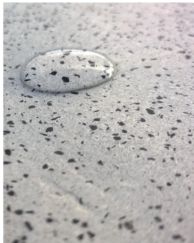
Met Colorfresh® intensiv behandelde beton – water parelt af
